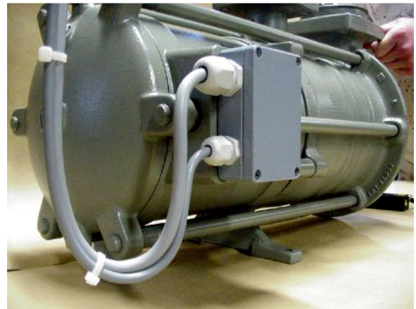
Abb.9 b Richtige Kabelzuführung mit Bogen Fig. 9 b Correct connection with loop in electrical cable
